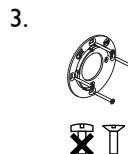
Прикрутите поворотную основу к стене, используя винты с потайной шляпкой
